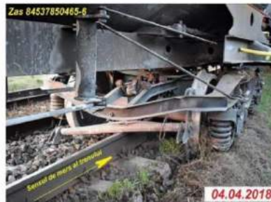
Foto nr.1 - Poziția boghiului deraiat după oprirea trenului
