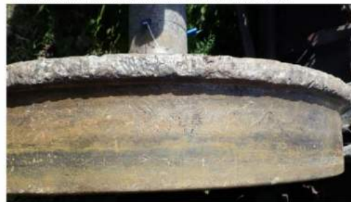
Foto nr.10 – Aspectul suprafeței de rulare și buzei bandajului ca urmare a circulației în stare deraiată
