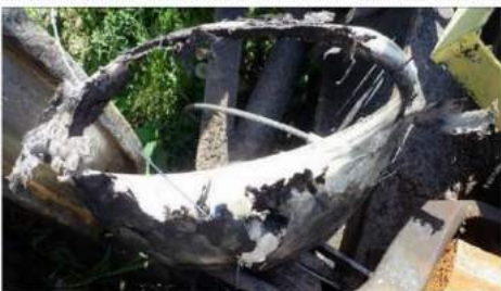
Foto nr. 13 - Starea plăcii de poliamidă de la boghiul cu roțile 1-4 în urma deraierei
