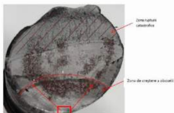
Figura 4. Suprafața de rupere a barei antirului
