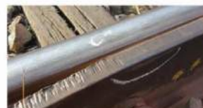
Imaginea nr. 7 Punctul C – urmă de frecare în exteriorul contrașinei (spre interiorul căii)
