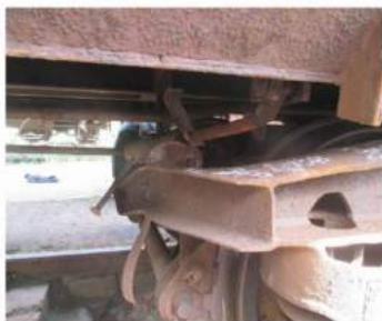
Figura nr.10 - poziția dispozitivului de asigurare a trapei din dreptul roții nr.6 imediat după deraiere
