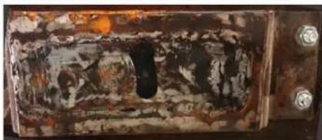
Foto nr. 12 - Piatră de frecare superioară, recondiționată
