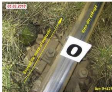
Foto nr.2 - Punctul de cădere „0” al roții din stânga osiei nr.1 de la primul boghiu al vagonului, nr.335449600253
